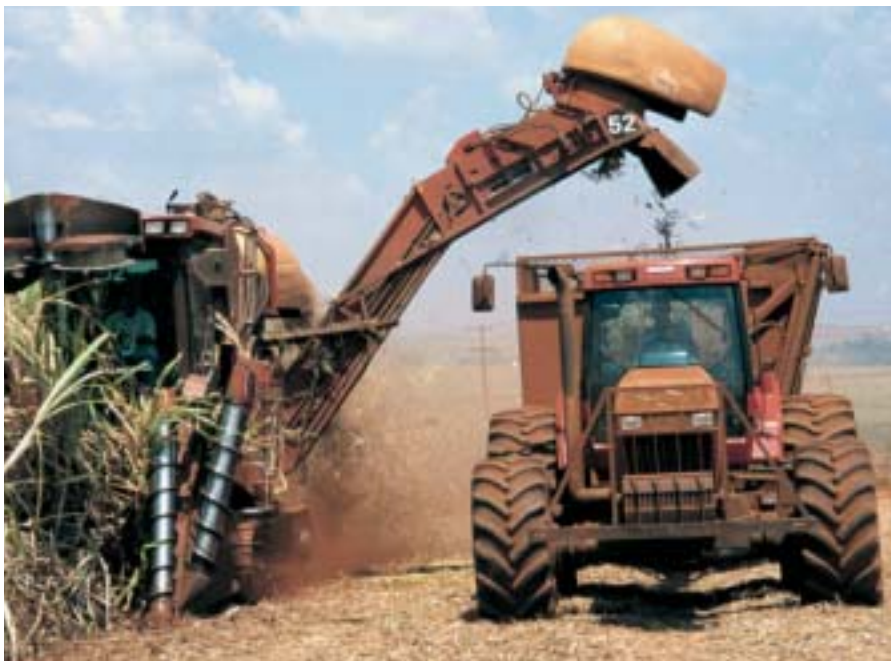
Sockerrörströskor med Scaniamotorer i Brasilien skördar ett ton sockerrör per minut.
